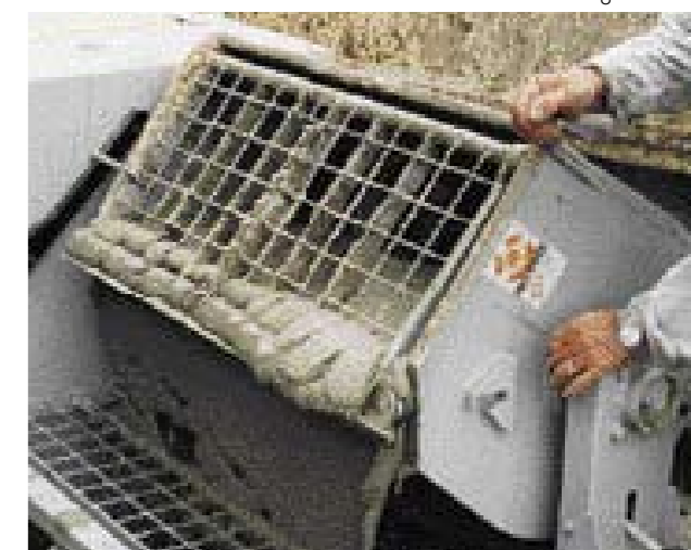
El mezclador giratorio del modelo BMB es una versión cómoda que facilita enormemente el trabajo.
