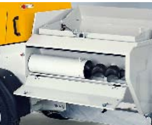
Práctico: aquí puede guardar herramientas o un tornillo sinfín de repuesto.
